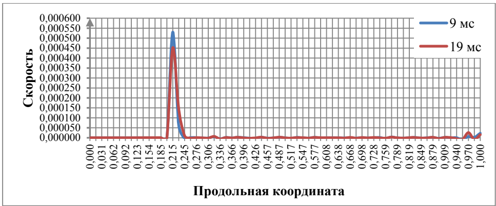
Рис. 5. График распределения компоненты вектора скорости \bar{v}_3(\tilde{x}_3) (м/с) в пластине из тканевого композита при фильтрации в нем жидкого связующего для случая отсутствия перепада внешнего давления p_{e2} - p_{e3}
