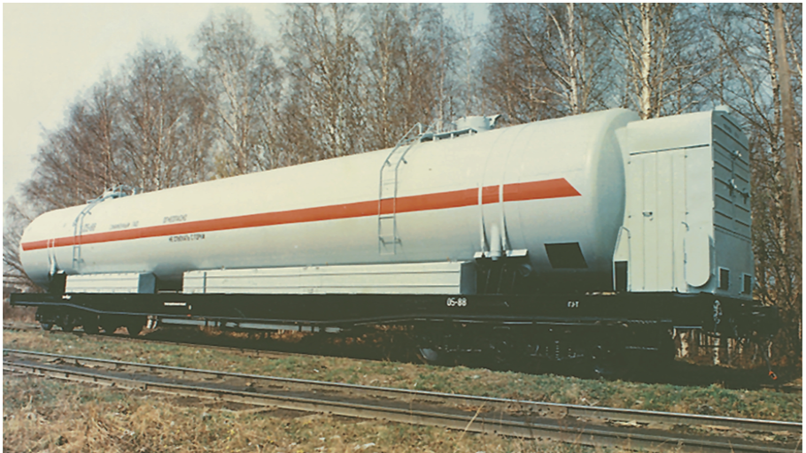
Рис. 4. Железнодорожная цистерна модели ЖВЦ-100М для транспортировки жидкого водорода
