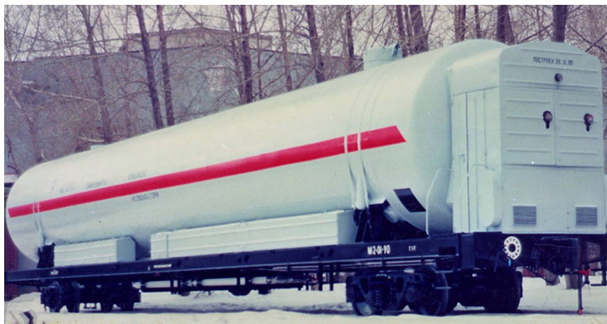
Рис. 5. Железнодорожная цистерна модели ЖВЦ-100М2 для транспортировки жидкого водорода
