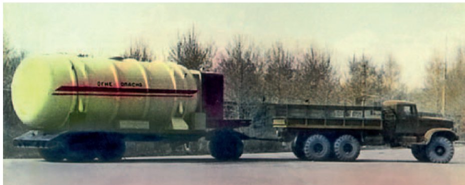
Рис. 1. Транспортный резервуар модели ТРЖВ-20 для транспортировки жидкого водорода
