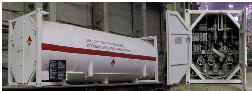
Рис. 6. Контейнер-цистерна для перевозки жидкого водорода
