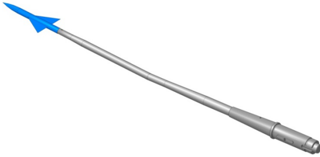
Рис. 3. Схематизированная модель сверхзвукового летательного аппарата на изогнутой державке
