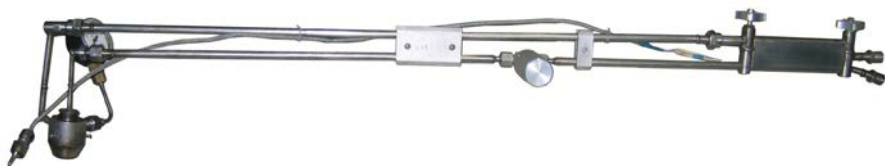
Рис. 2. Терморезак УТР-2С с экспериментальной головкой
