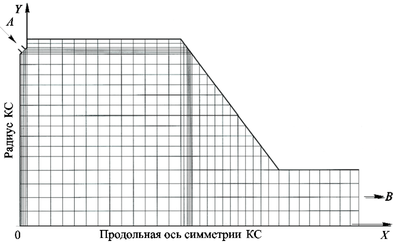
Рис. 4. Расчетная схема распределения параметров по объему КС головки терморезака
