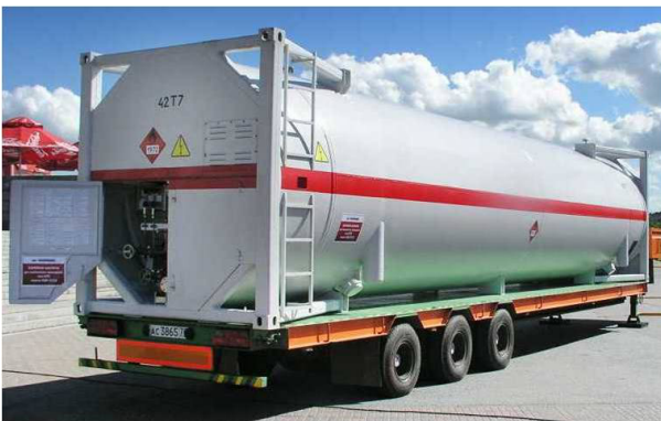
Рис. 6. Контейнер-цистерна модели КЦМ-35/06 для транспортировки СПГ
