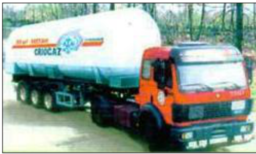
Рис. 2. Автомобильная цистерна объемом 30 \text{ м}^3 для транспортировки СПГ
