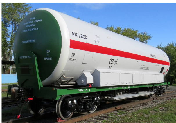
Рис. 4. Вагон-цистерна модели 15-5106 для транспортировки СПГ и этилена
