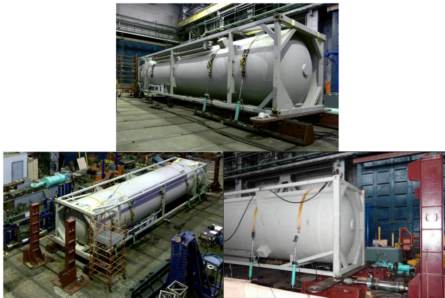
Рис. 9. Статические испытания контейнера-цистерны модели КЦМ-40/0,7
