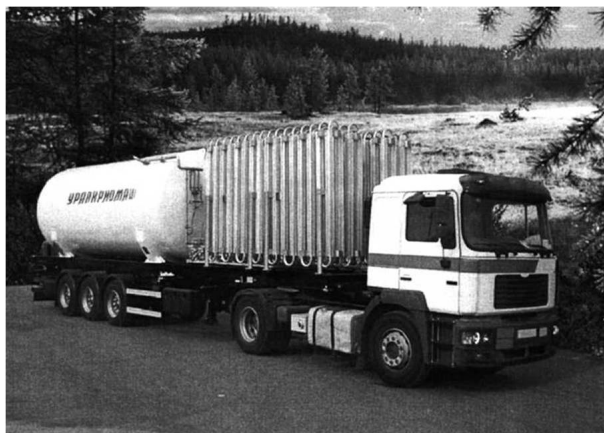
Рис. 10. Криогенный транспортный комплекс контейнер-цистерна и газификатор
