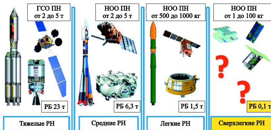
Рис. 1. Существующие средства выведения на геостационарную орбиту (ГСО) и низкую опорную орбиту (НОО) перспективной полезной нагрузки (ПН)
