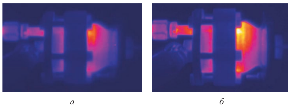
Рис. 5. Характерные изображения температурного поля на наружной поверхности элементов конструкции модельного РДМТ для импульсных режимов работы на 10 с работы:
