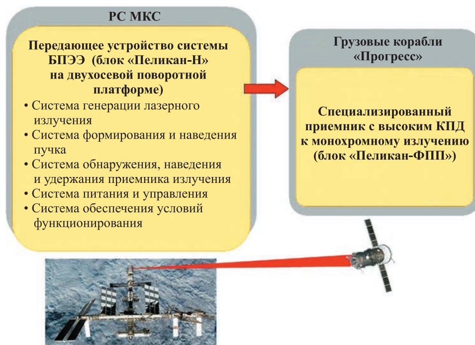
Рис. 1. Схема размещения научной аппаратуры для проведения космического эксперимента «Пеликан» (дальность передачи энергии 1...5 км; передаваемая мощность 50...1000 Вт; продолжительность одного сеанса 1,5...5,0 мин)
