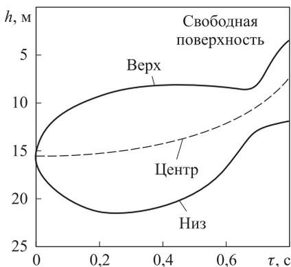
**Рис. 2.** Перемещения газового пузыря, образовавшегося при взрыве заряда тротила массой 137 кг на глубине 15 м под свободной поверхностью [1]
