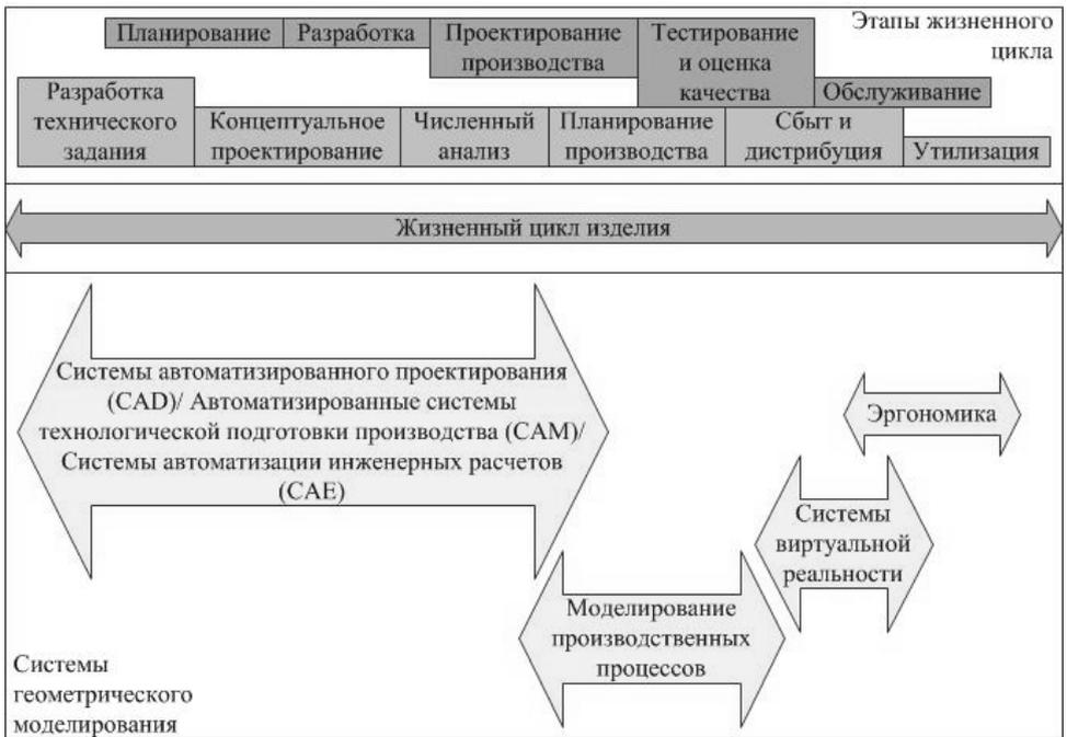
**Рис. 6.** Сопоставление этапов жизненного цикла и задач средств автоматизации
