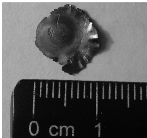
Рис. 2. Образец после деформации, проведенной за два оборота бойка
