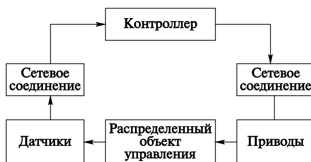
Рис. 1. Сетевая система управления
