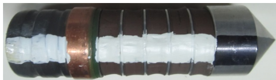
Рис. 2. Макетный снаряд с элементами твердого топлива для этапа II испытаний
